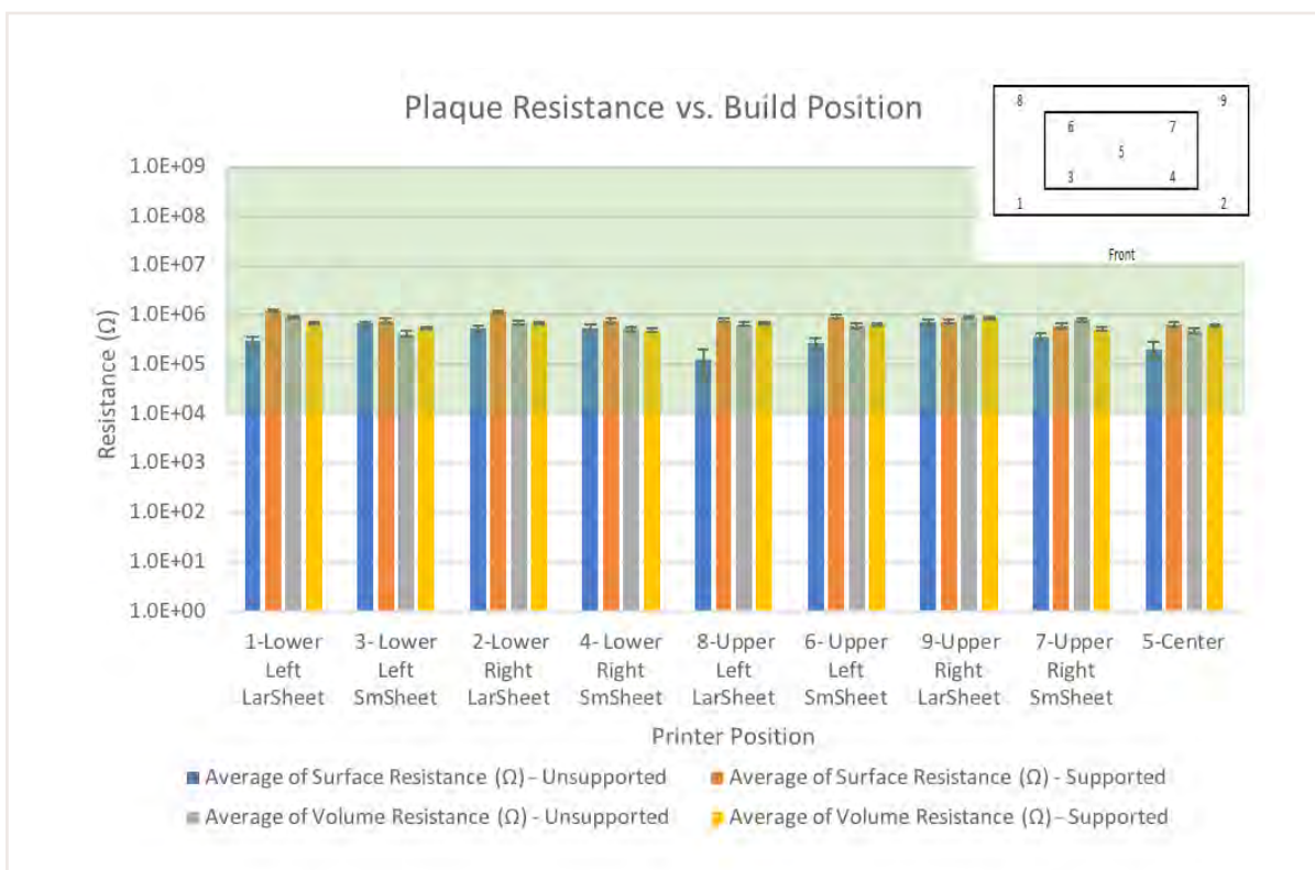
图 6: 板打印位置与零件电阻。
