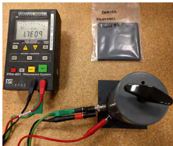
图 1：带同心圆探头的 PRS 电阻表。
