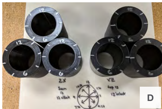
图 2: ESD 套件的测试零件示例。 A) 板，45 度。B) 板，侧放 (ZX)。C) 薄（壁厚 0.05）圆柱。D) 厚（壁厚 0.20）圆柱。
