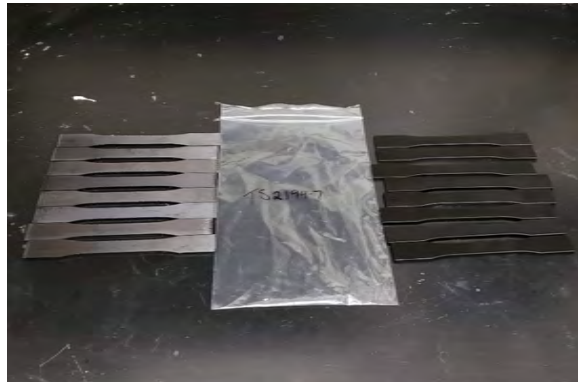
图 7: 接触 Jet A 后的样
