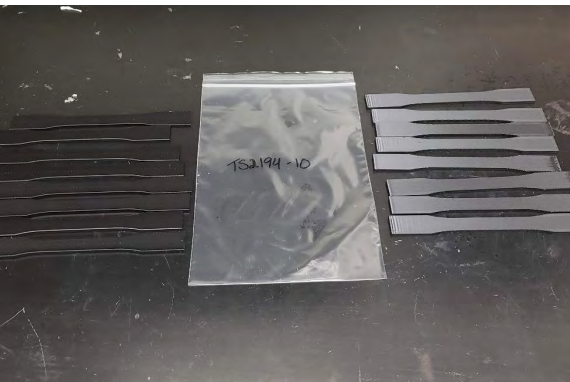
图 10: 接触 60% 氢氧化钠后的样品。
