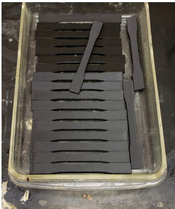
图 1: 接触化学品前的打印样品。
