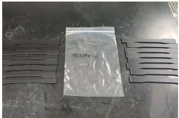
图 11: 接触浓氢氧化铵后的样品。
