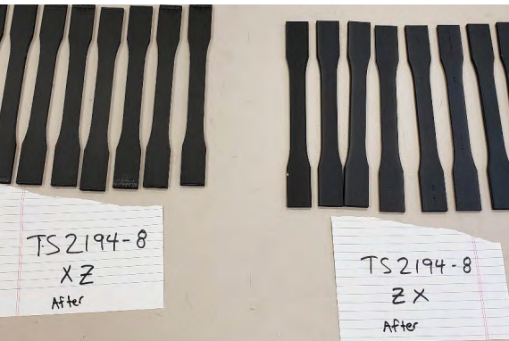
图 8: 接触 30% 硝酸后的样品。
