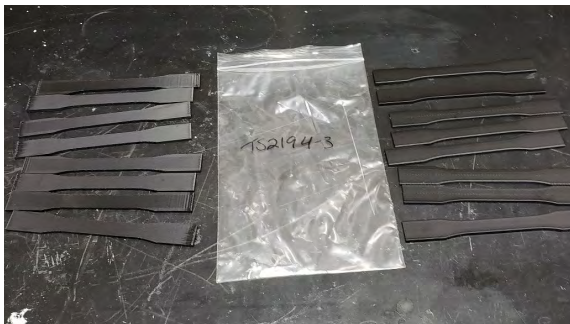
图 3: 接触 MEK 后的样品。
