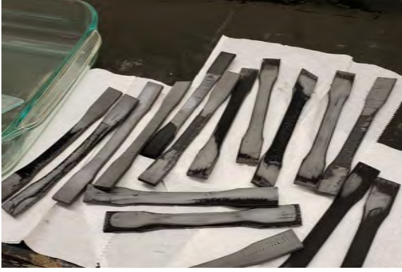
图 4: 接触 DCM 后的样品。
