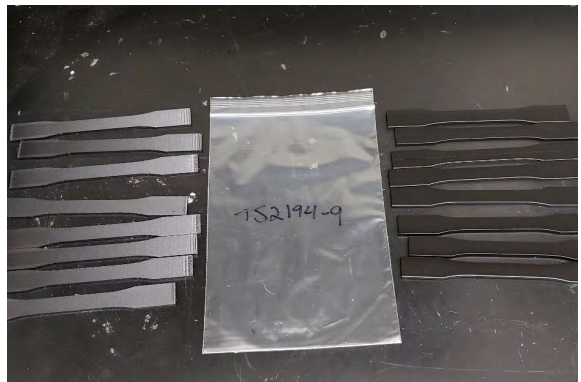
图 9: 接触 30% 硫酸后的样品。
