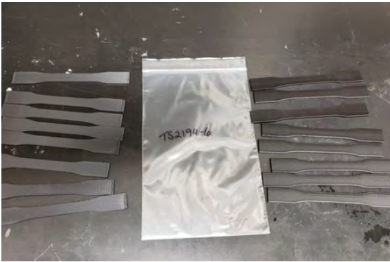
图 6: 接触甲苯后的样品。
