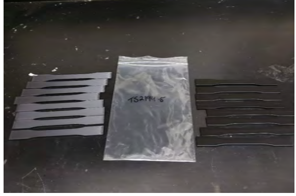
图 5: 接触乙酸乙酯后的样品。
