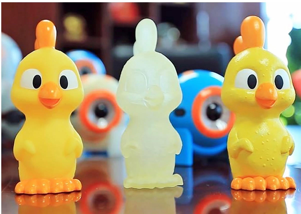
图为 3D 打印模型（中和右）与大规模生产成品（左）。
