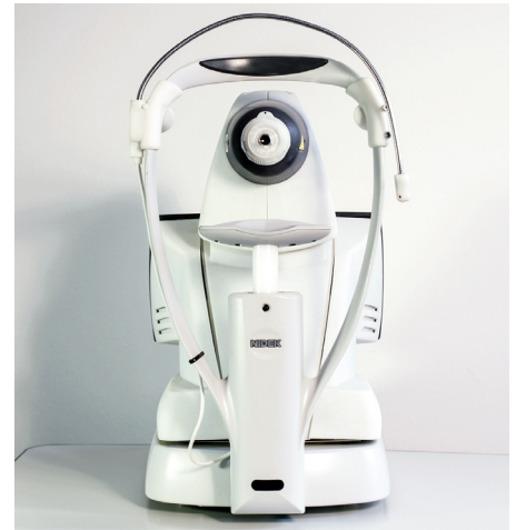
用 3D 打印零件组装的 Gonioscope ® 原型。
